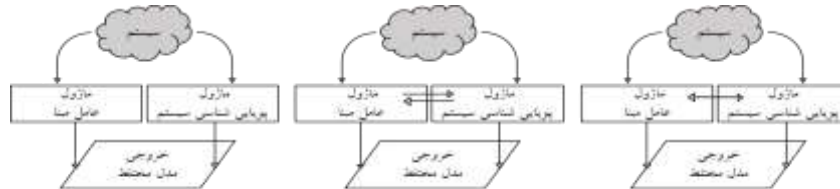
شکل ۵. معماری‌های پایه شبیه‌سازی مختلط مدل‌های عامل‌مبنا و پویاشناسی سیستم
